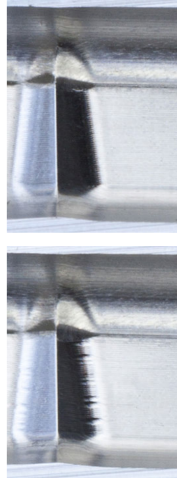
上图:用ADP功能铣削的工件 下图:未用ADP功能铣削的工件
